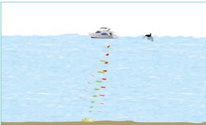
ACOUSTIC TELEMTRY PROVIDES NEAR-REAL-TIME DATA TRANSFER BETWEEN THE AQUARIUS OBS SYSTEM ON THE SEABED AND THE SURFACE
